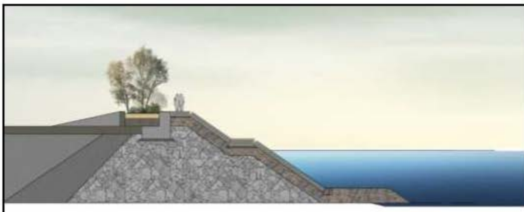
图 14.4-8 人工岛东北侧生态护岸结构图
