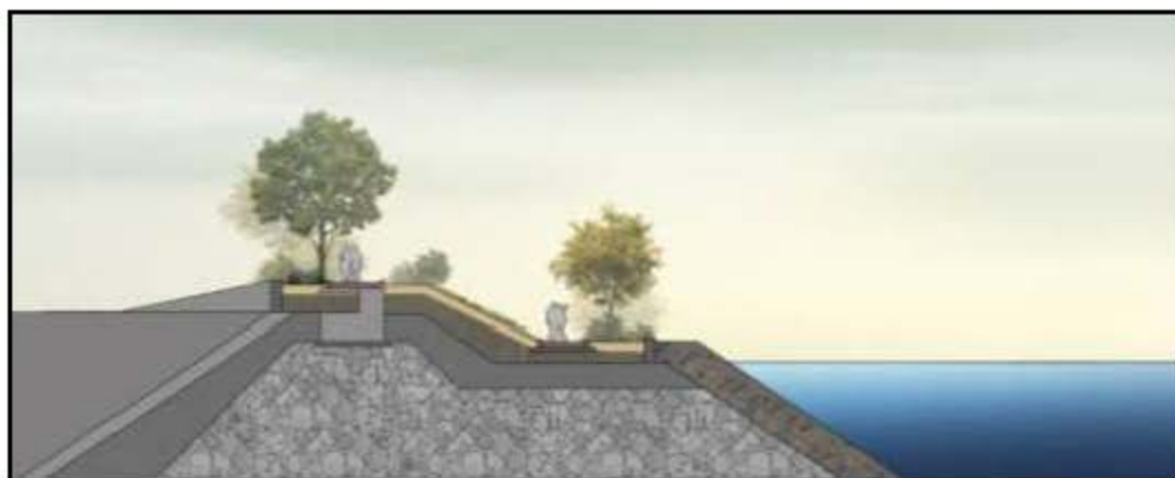
图 14.4-7 人工岛东南侧生态护岸结构图
