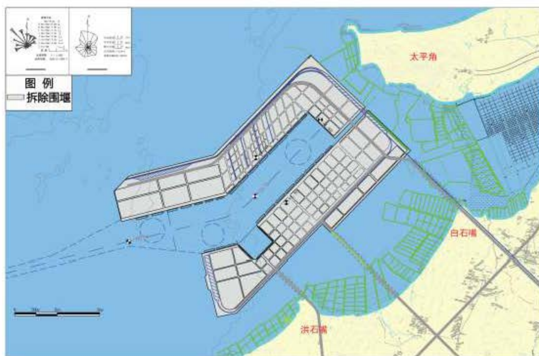
图 14.4-1 拆除过度用海工程示意图
