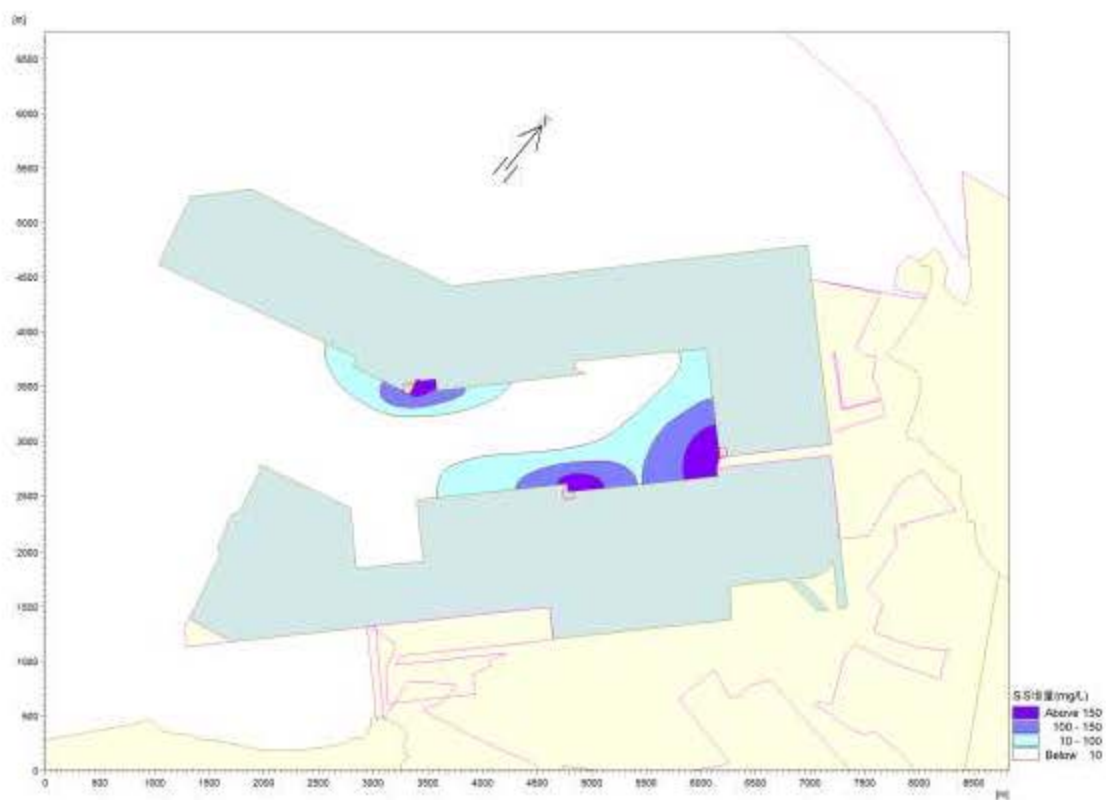
图 6.3-6 吹填溢流悬浮物浓度增量包络线
