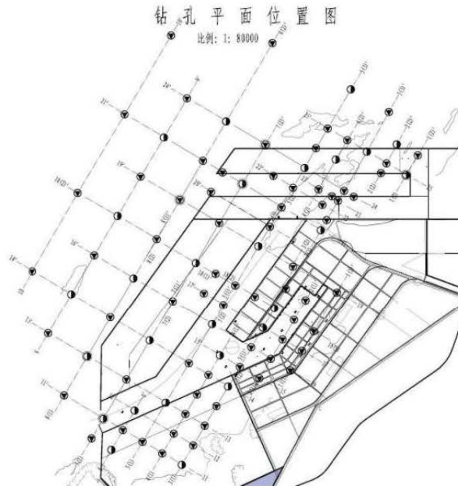
图 4.1-9 规划设计阶段钻孔平面布置图
