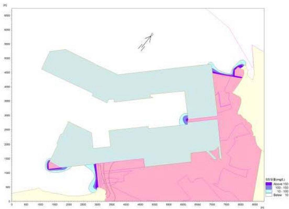
图 6.3-8 养殖围堰+超填区域拆除施工悬浮物浓度增量包络线
